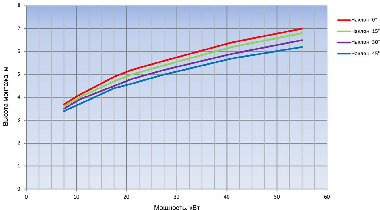
Если температура воздуха в помещении отличается от 10°C, положение кривых уточняется (смещается вертикально) в соответствии с поправочными коэффициентами, представленными в таблице.
