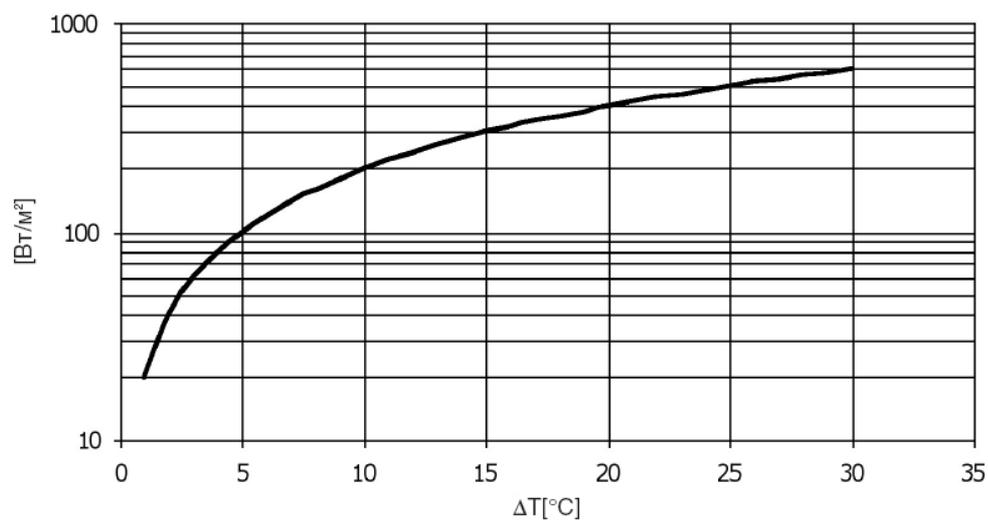
Из диаграммы на Рисунке 2.6, с учетом площади зоны обогрева и разницы температур, можно определить необходимую мощность оборудования EUCERAMIC.
