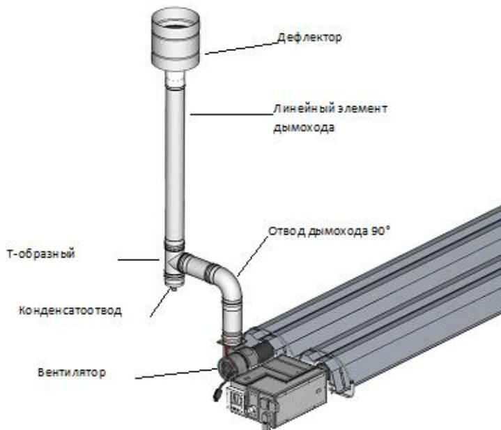
Для установки воздухозаборной трубы, к горелке крепится специальное фланцевое соединение на место защитной решетки. Если излучатели заказаны уже с системой воздухозабора, в комплект горелки уже входит специальный воздухозаборный фланец. В противном случае, необходимо произвести следующие изменения.
