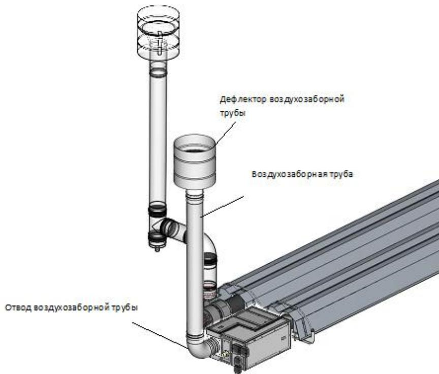
Определение длины труб дымоудаления/воздухозабора должно проводится так, чтобы трубы выходили через крышу или стены помещения с учетом минимального расстояния, указанного нормами безопасности по газовому оборудованию (Рис. 3.31-3.37)) и не превышали общих расстояний, указанных в Таблице 3.2.
