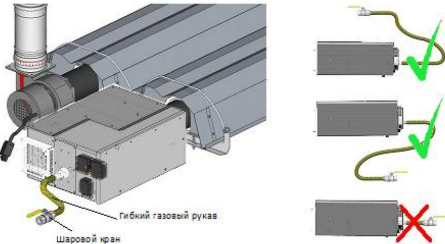
**ПРИМЕЧАНИЕ:** Используйте гибкий газовый рукав адекватной длины, обеспечивающей свободное перемещение горелки при работе излучателя и компенсацию температурного расширения труб (см. рисунок 3.39).
