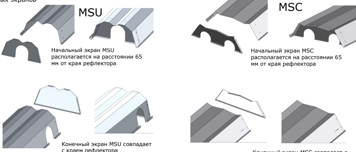
Крепление торцевых экранов производится через специально подготовленные на заводе-изготовителе отверстия в рефлекторах с помощью заклепок, входящих в комплект крепления кронштейнов.
