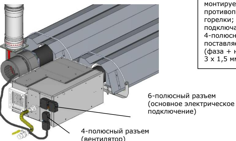
В модели MSM вентилятор монтируется с противоположной стороны горелки; вентилятор подключается с помощью 4-полюсных разъемов, поставляемых отдельно (фаза + нейтраль + земля, 3 x 1,5 мм<sup>2</sup>).
