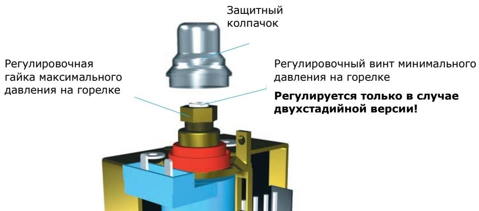
С помощью отвёртки отрегулируйте пластиковый винт минимального давления, согласно графе "**Давление на сопле**" в таблице 4.4 ниже.
