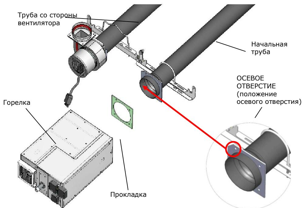
Закрепите горелку (газогорелочный блок) к соответствующей трубе с фланцевым соединением, используя прокладку и крепеж, поставляемый в комплекте (Рисунок 3.18).
