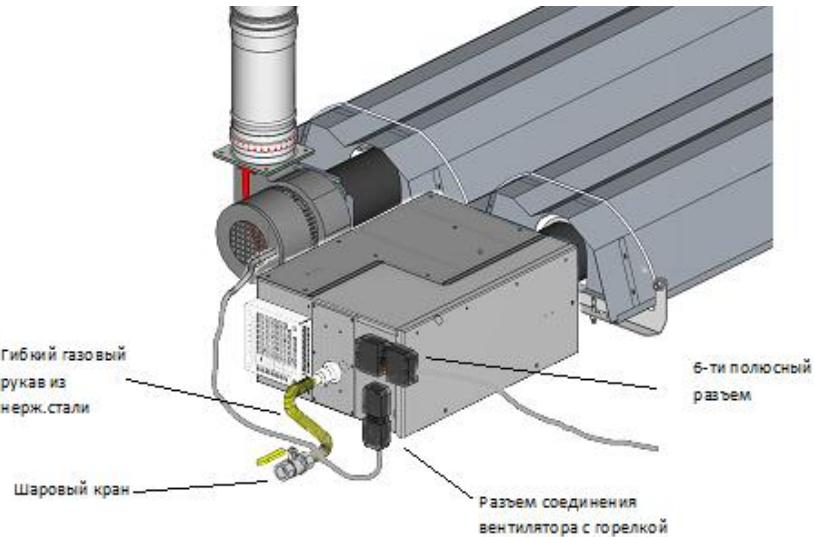
При работающей горелке проверьте давление на входе группы клапанов, как показано на Рисунке 4.3. Параметры давления приведены в Таблице 4.4.
