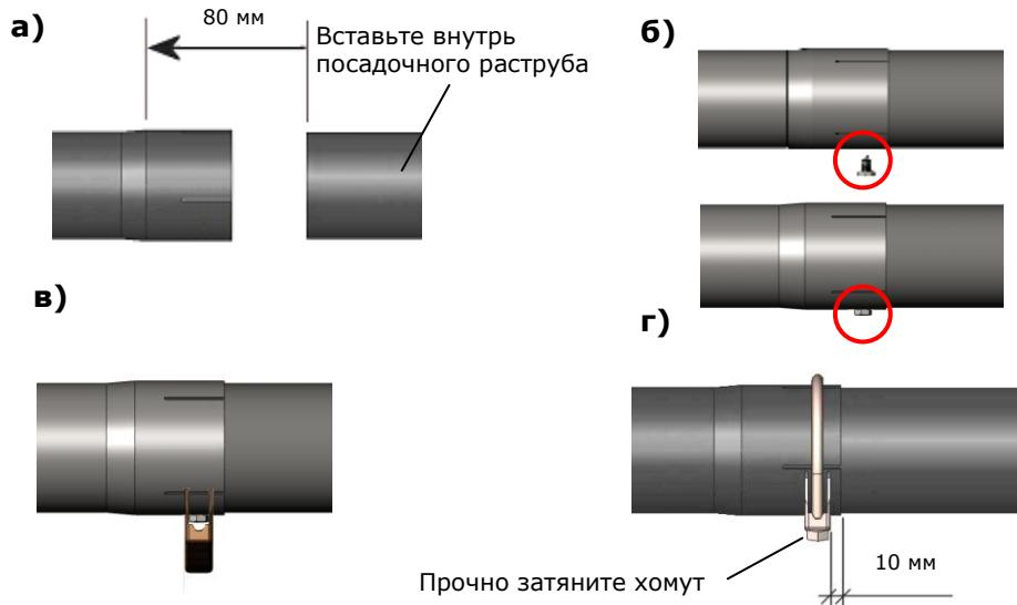
**а)** Вставьте трубу в посадочный растрруб на глубину 80 мм. **б)** Зафиксируйте соединение между начальной и последующей трубой с помощью самореза со сверлящей головкой (входит в комплект, поставляется закрепленным в монтажном отверстии начальной трубы). Соединение саморезом требуется только для начальной трубы. **в)** Наложите на шляпку самореза колодку хомута. **г)** Затяните хомут максимально прочно.
