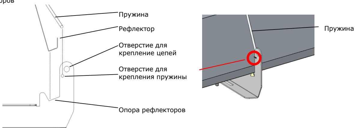
3. Далее накладывается следующий рефлектор. При этом каждый последующий должен накрывать предыдущий (см. рисунки 3.7 – 3.11). Последними будут установлены начальные рефлекторы.
