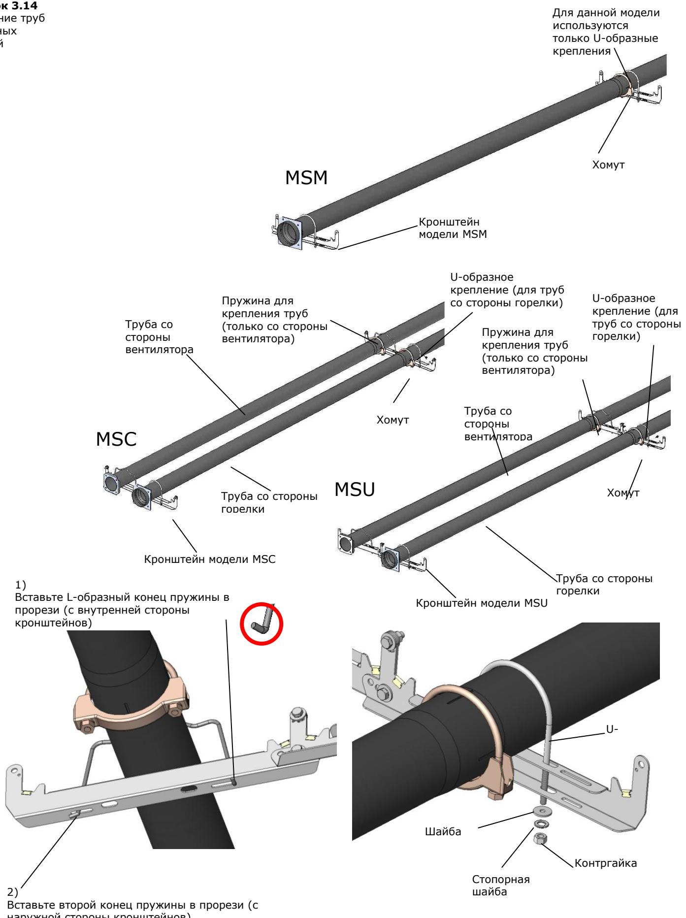
Соедините колено с трубами (в моделях MSC и MSU). Вставьте колено в трубы примерно на 80 мм. Закрепите хомут в 10 мм от конца внутренней трубы. Плотно закрепите хомут (Рисунок 3.15).
